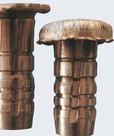
7 mm-FIP, 9,55 g | ▶ Deformation in 4-cm-Gelatine, bei 883 m/s Auftreff- geschwindigkeit.
