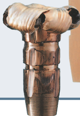
7 mm-FIP, 9,55 g | ▶ Deformation in 4-cm-Gelatine, bei 883 m/s Auftreff- geschwindigkeit.
